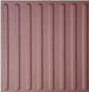
Do tipo cimentício, na cor vermelha, medindo 0,25 m x 0,25m e 0,025m de espessura mínima, este piso deve ser utilizado como guia de caminamento orientador do deficiente visual, quando obrigatório na faixa acessível definida nesta cartilha, e excepcionalmente em rotas preferenciais de circulação, determinadas pelo município.
